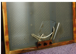
Bass-Wandler mit beschädigter Staubschutzfolie
